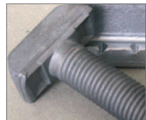
Kerbzähne der Schraube drücken sich in die Schienenlippe ein.
