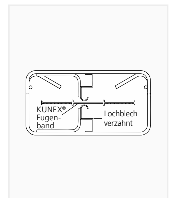
KUNEX® ABS-V Wand/Wand, verzahnte Fuge nach EC2.
