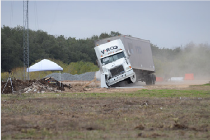
Anprallversuch mit 80 km/h eines 36.000 kg schweren LkW
