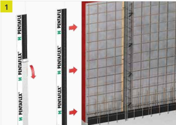
Äußere Schalung stellen und an der Position der Arbeitsfuge Trapezleiste anbringen. Äußere Bewehrung einbringen. WU-taugliche Abstandhalter verwenden! ABS Element über das PENTAFLEX KB® der Boden/Wand -Fuge stellen und mit der Bewehrung verrödeln oder verschweißen. Schutzpapier im Bereich des ersten Betonierabschnittes beidseitig abziehen und das Blech bis zum Anschlag in die Abschalung einstecken.
