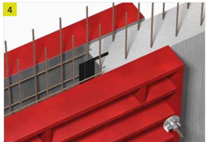
Vor dem Einschalen des zweiten Betonierabschnittes die restliche Schutzfolie des PENTAFLEX KB® entfernen, Bauteil bewehren und Schalung schließen.
